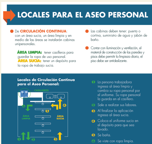
Figura 4. Esquema de locales para uso de las personas que realizan labores de manejo y uso de plaguicidas.
